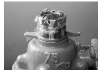
写真1 口金洗浄の状態
