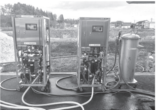
珠洲市に2台設置されたユニットと活性炭ユニット、アクアレスキュー
